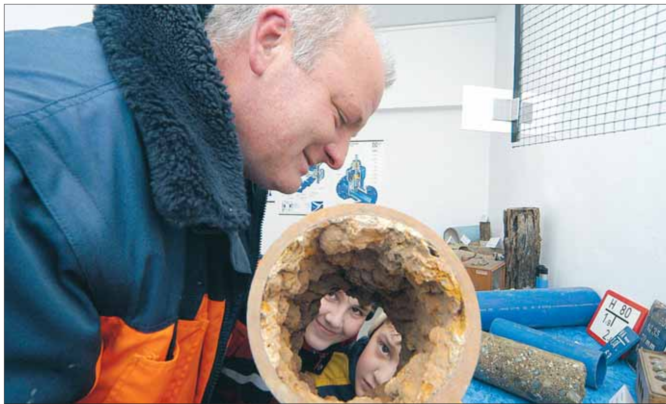
Karl und Peter Leibl schauen im Beisein von Rohrnetzmeister Hans-Peter Sewina in ein stark verkrustetes Gussrohr, das zum Tag des Wassers im Wasserwerk Schönfeld zu sehen war. Das Rohr diente seit 1900 in Greiz als Wasserleitung.
